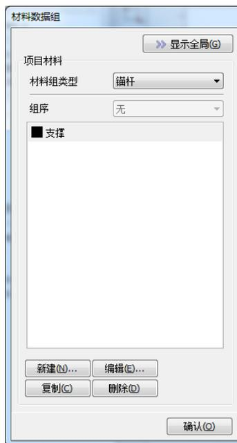
图 1.11 材料数据组窗口一内支撑材料属性
