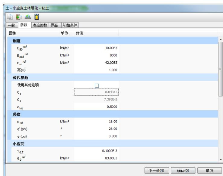
图 1.3 土层材料属性—参数定义
